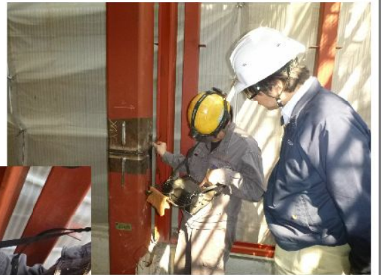
超音波探傷試験による 検査中
